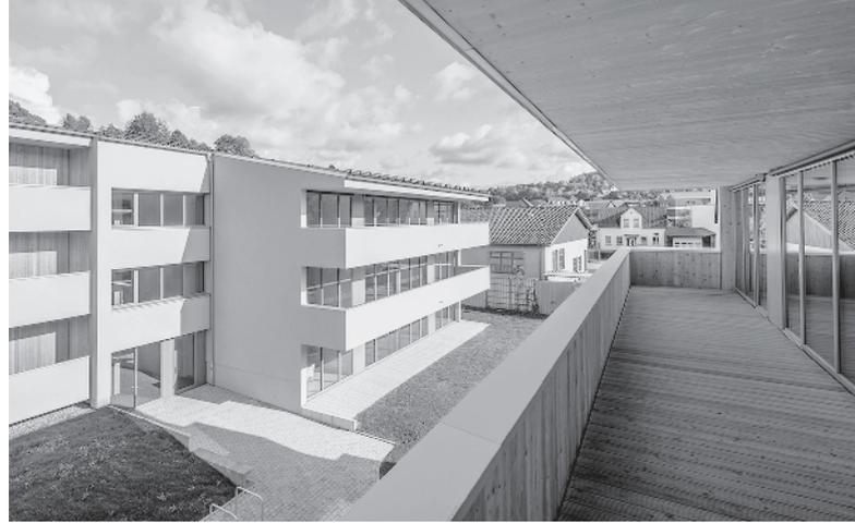
schutztechnischen Maßnahmen notwendig, wobei die Balkone im Sinne des Brandschutzes für die Wohnungen als zweiter Rettungsweg dienen. Ihr Bodenaufbau begnügt sich oberhalb der Hohlkastendecken mit EPS-Gefälledämmung, Folienabdichtung, Stelzlager und Lärchenholzdielen auf einer Unterkonstruktion. Die Brüstungen sind eine Kombination aus einem Wärmedämmverbundsystem (außen) mit einer Bekleidung aus Massivholzplatten in Lärche (innen).
