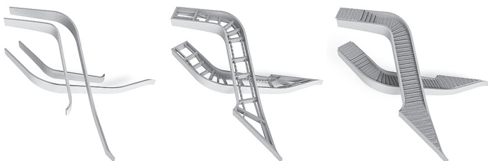
Die Treppe in Stavanger ist als torsionssteifer Trogquerschnitt konstruiert. Für die seitlichen Wangen und die Querträger wurden Brettschichtholz-Träger verwendet, für die Stufen Buchenfurnierschichtholz.
