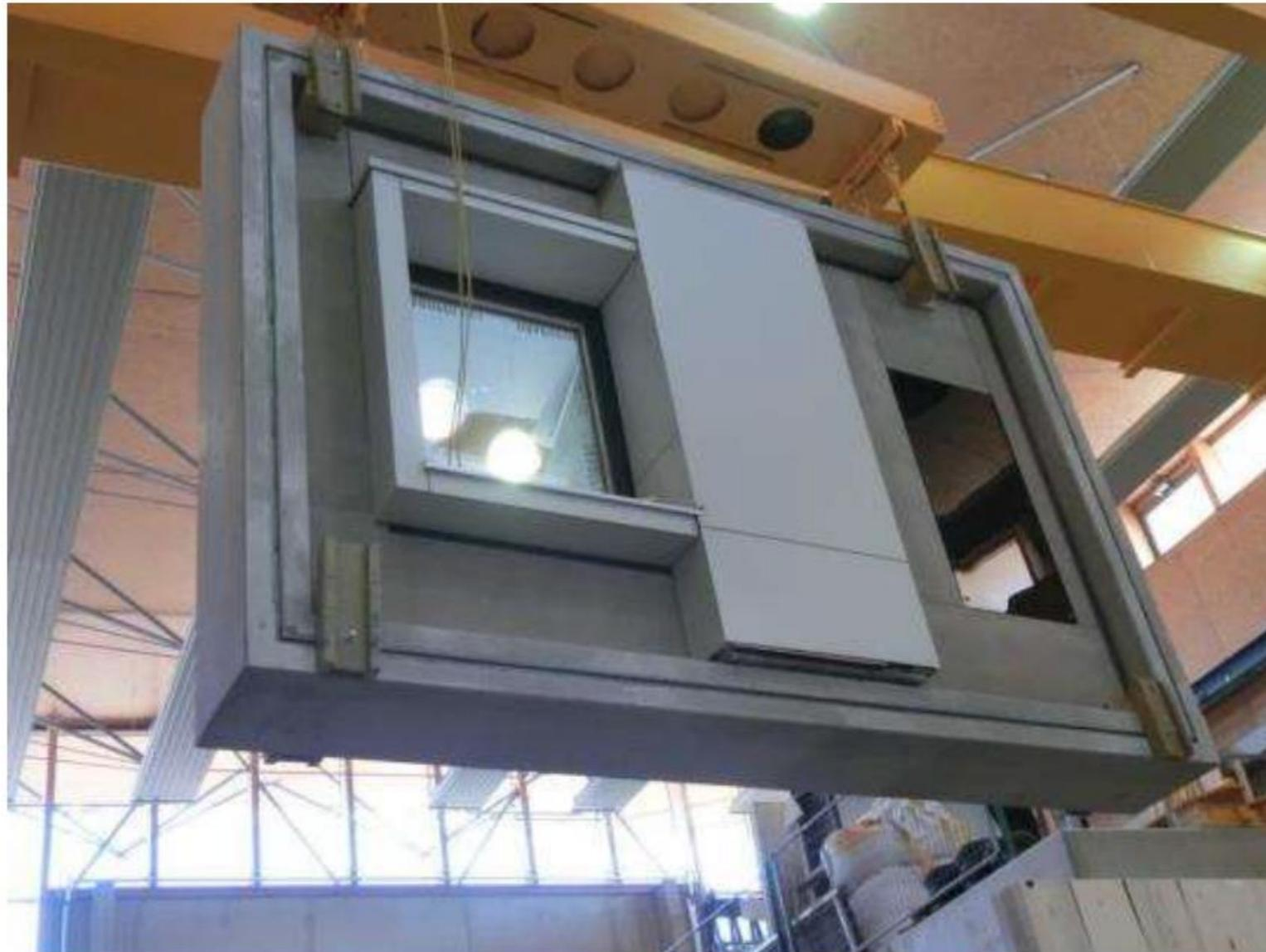
Abbildung 67: Einheben des gesamten Vorhangfassadenmoduls im Labor für Bauphysik der TU Graz
