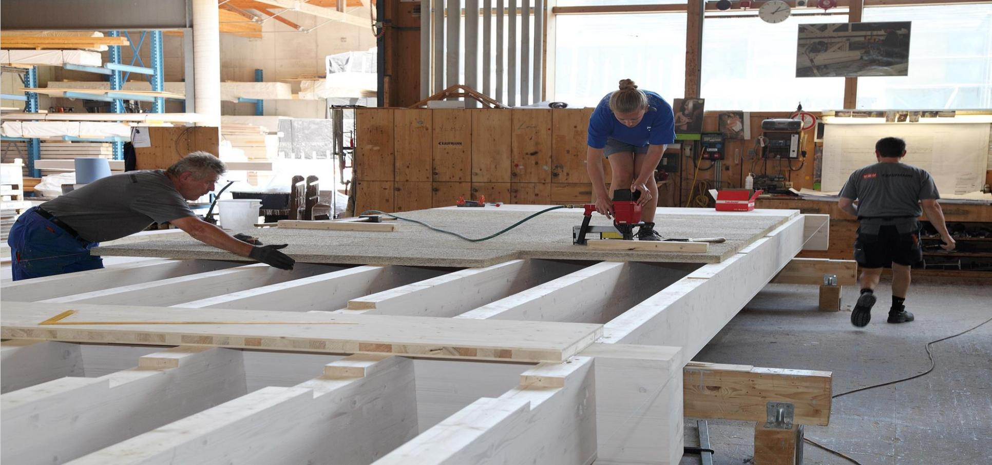
Holzrahmenbau, materialoptimiert, da Holzeinsatz nur bei Lastabführung. Hochwärmedämmend und platzsparend! Wertschöpfung
