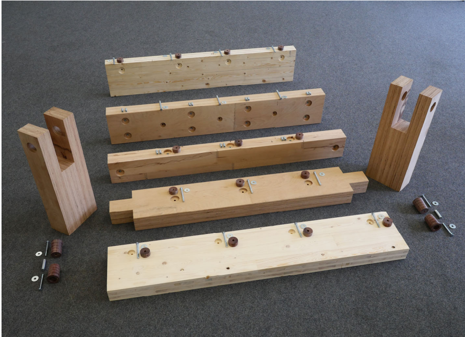
Graf J., Birk S. et al., Reversible Einzelbauteile eines I-profilierten Trägers mit Anschluss an Stützen
